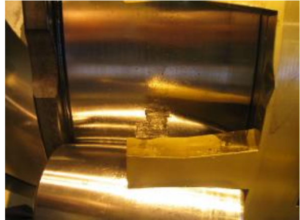
KUVA 5: Vaurioitunut telan laakeri
