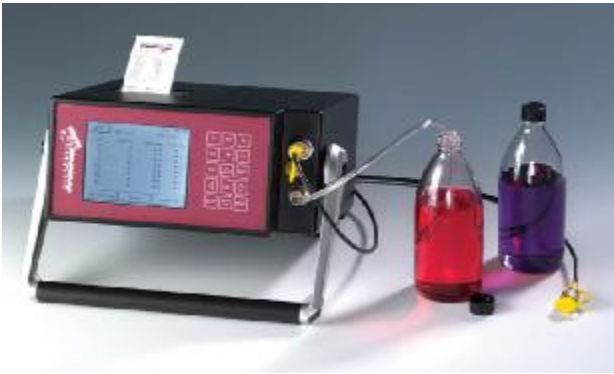
KUVA 1: PAMAS S40 hiukkaslaskin mittaa hiukkasmäärät kahdeksalla kokoluokalla
